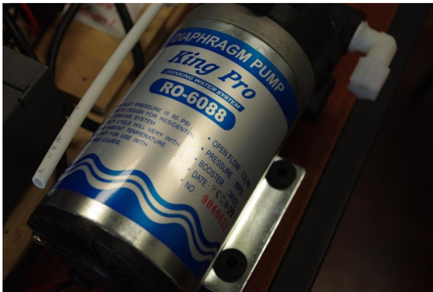
Figure9. Mini Diaphragm pump.Model No.Ro-6088, King Pro
